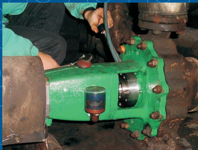
Uszczelnienie typu 45GF zabudowane w pompie 5A25A prod. WAFAPOMP
