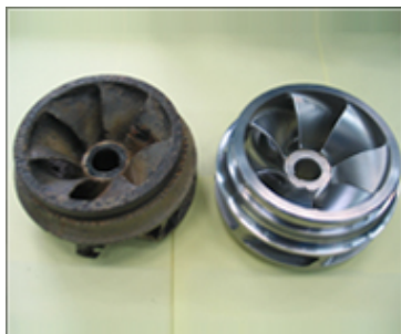
wirnik pompy, przed i po remoncie
